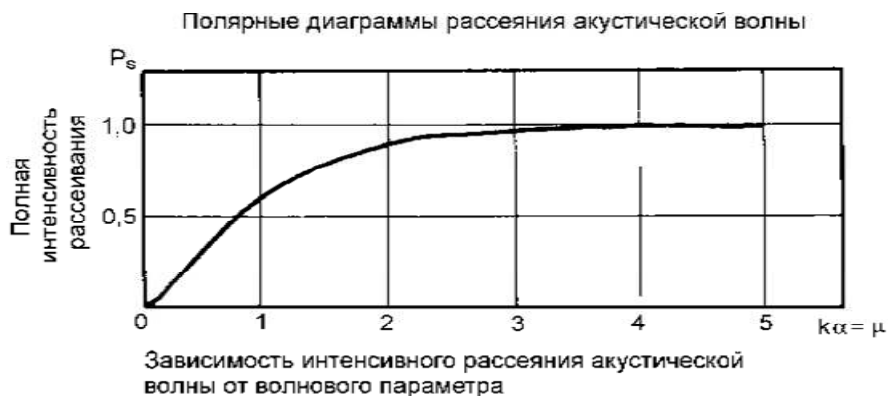
Рис. 4.2.3. Зависимость рассеянной единицей длины цилиндра полной мощности волны от величины параметра \mu
