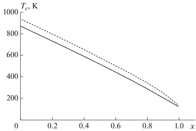
Рис. 3. График зависимости значений точки Кюри (сплошная линия) и парамагнитной точки Кюри (пунктирная линия) от концентрации ионов титана.
