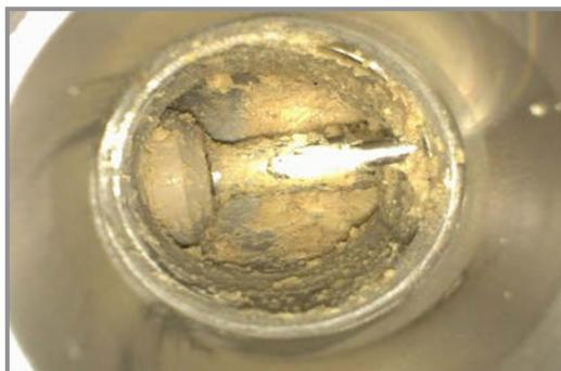
**Рис. 1. Влагомер с замерного узла ачимовского конденсата на ЗПКТ**
