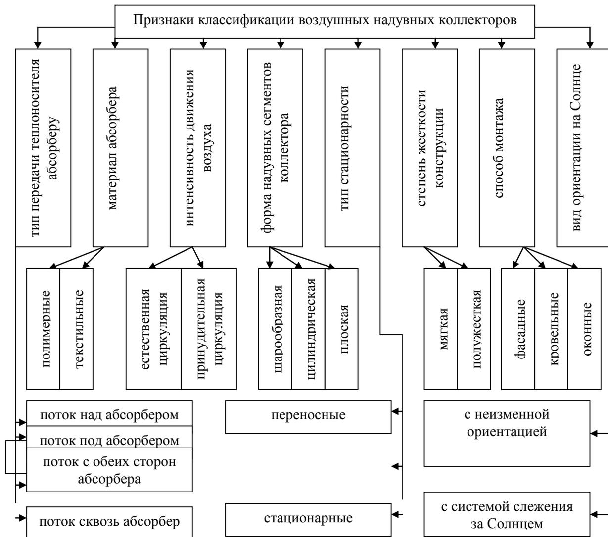
**Рис. 1. Конструктивно-техническая классификация воздушных надувных коллекторов**
