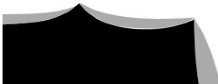
Рис. 2.31. Неравномерность толщины защитного покрытия по поверхности твердого тела
