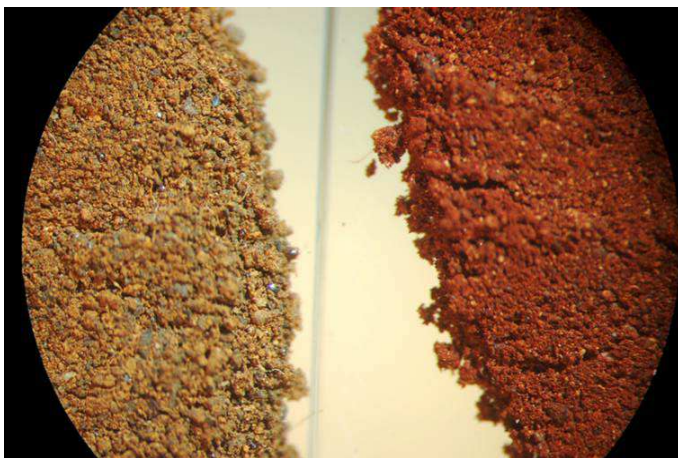
Рис. 2.25. Цвет продукта коррозии до обработки (слева) и после обработки (справа)
