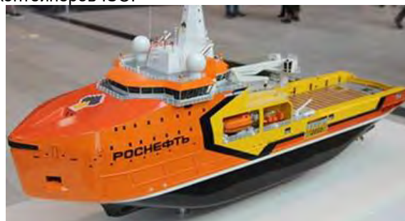
Рис. 11. Модель многоцелевого судна снабжения усиленного ледового класса, строящегося на верфи ССК «Звезда» по проекту IBSV 10022 АН
