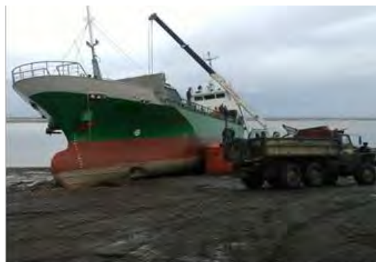
Рис. 7. Пример положения на грунте килеватого судна с креном на правый борт
