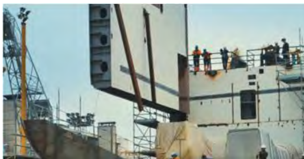
Рис. 16. Сборка корпусных модулей и плоских секций на достроечном стапеле верфи ССК «Звезда»
