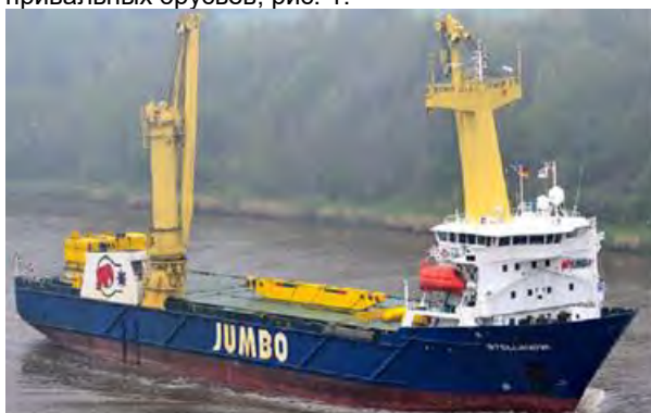
Рис. 1. Наружные усиления корпуса судна привальными брусьями для швартовок
