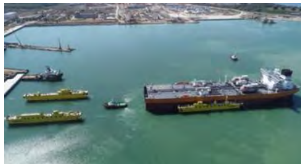
Рис. 20. Использование транспортно–передаточного дока для перемещения кормовой модульной части при сборке корпуса нефтеналивного судна проекта 114К
