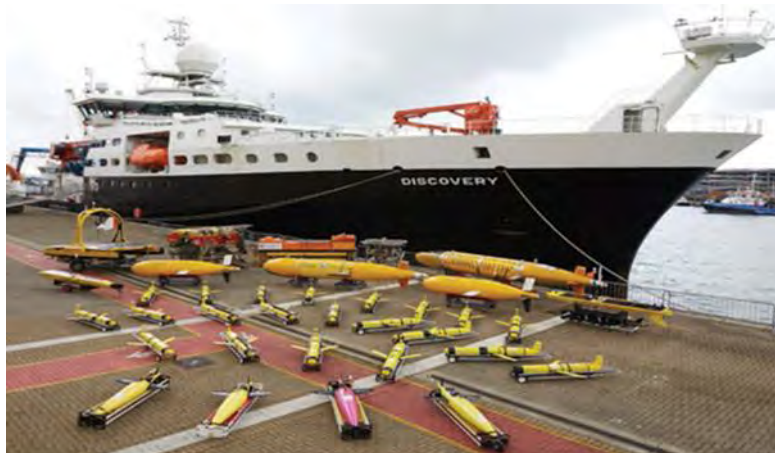
Рис. 9. Научно-исследовательское судно «Discovery» – носитель подводных аппаратов
