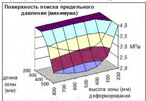
Рис. 7. Пример поверхности поиска предельной прочности для уровня 2 (система поперечная, полосы R30×500, угол 25°)
