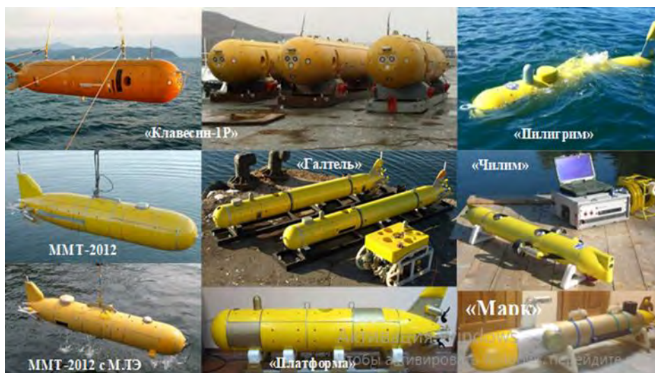
Рис. 10. Возможный состав подводных аппаратов на плавучей базе РТК
