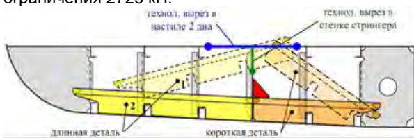
Рис. 11. Технологические вырезы для установки деталей полуфторов внутри двойного дна
