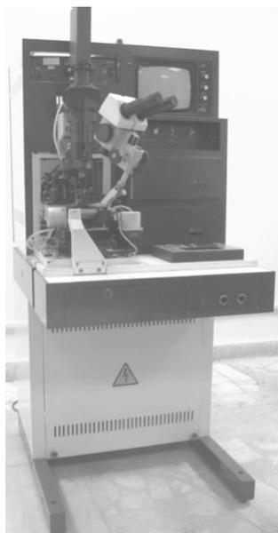
Рис. 2. Установка микросварки УЗСА-12
