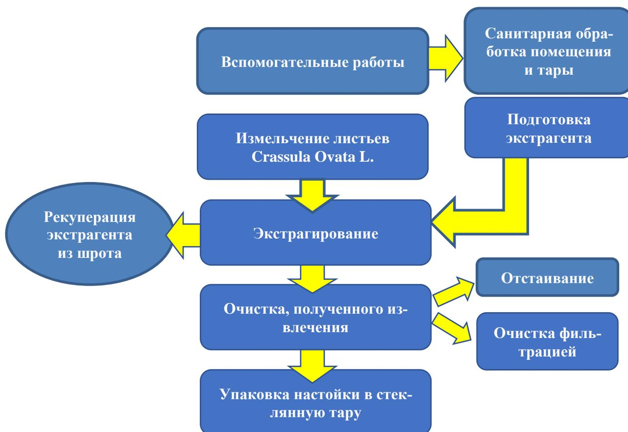
**Рис. 1. Технологическая схема получения настойки листьев толстянки**
