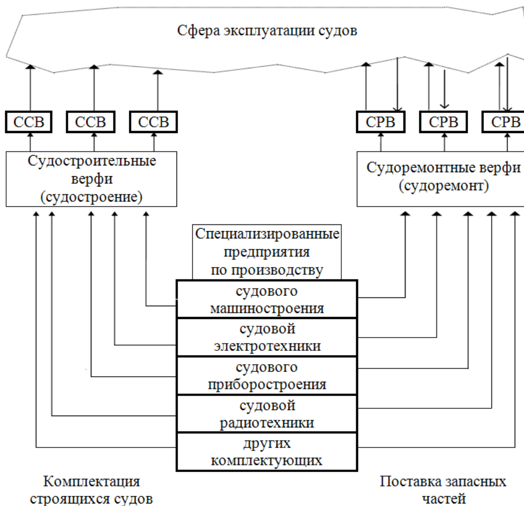
Рис. Схема формирования судостроительно-судоремонтного производственного комплекса, охватывающего все судостроительные и судоремонтные производства Дальнего Востока
