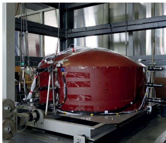
Рисунок 2. Модели резервуаров РВС-5000 и РВСПА-50000 на испытательном стенде
