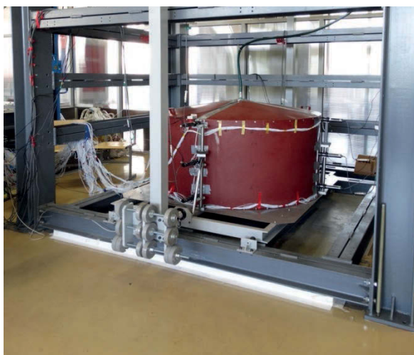
Рисунок 2. Модели резервуаров РВС-5000 и РВСПА-50000 на испытательном стенде
