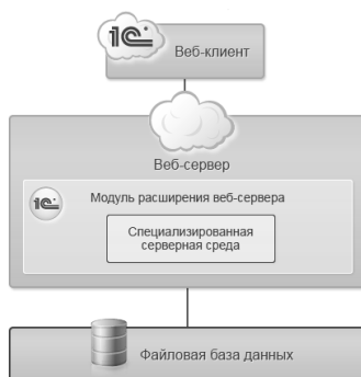
Рис. 4. Схема работы веб-клиента
