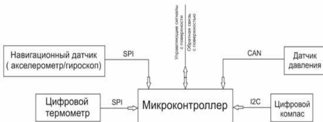
Рис. 1. Структурная схема подключения датчиков к микроконтроллеру
