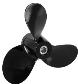
Рис. 5. Трехлопастной винт 7 3/8 X 5 3/8
