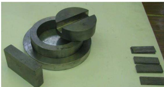
Рис. 1. Оснастка, предназначенная для проведения экспериментов по пластической осадке тонкой полосы
