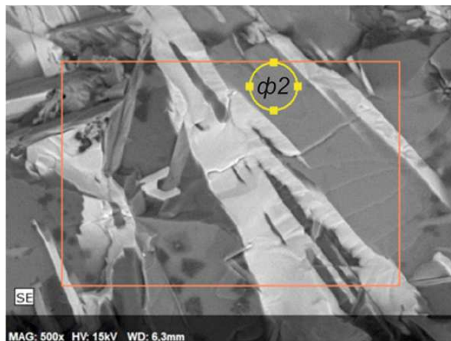
Рис. 9.4. Электронно-микроскопический снимок поверхности образца силикатной части расплава, охлажденного со скоростью 65 °/ч (кружком отмечена фаза 2)
