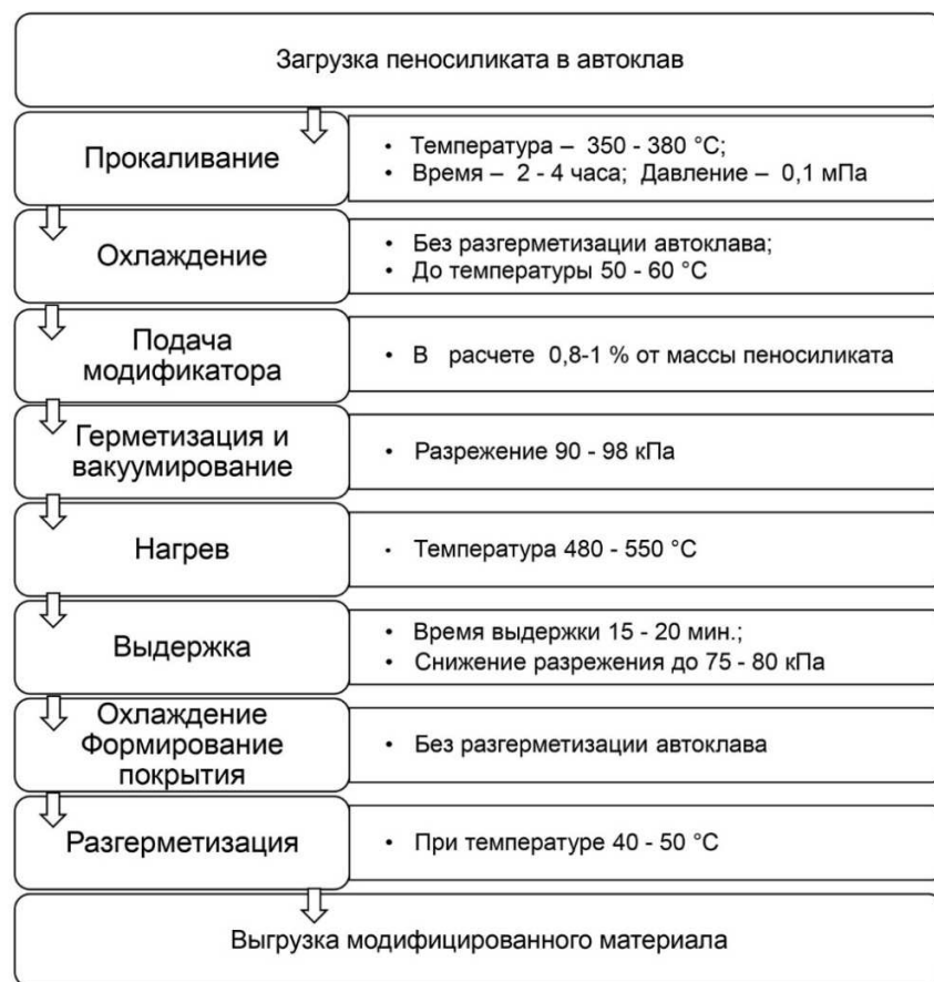
Рис. 10.3. Технологическая схема модифицирования поверхности пеносиликата
