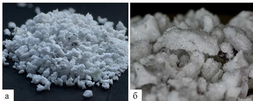
Рис. 10.1. Гранулированный пеносиликат: а – внешний вид пеносиликата; б – макросъёмка образца П1 объективом МС ГЕЛИОС-40-2-Н 1,5/85 с удлинительными кольцами кратностью х5
