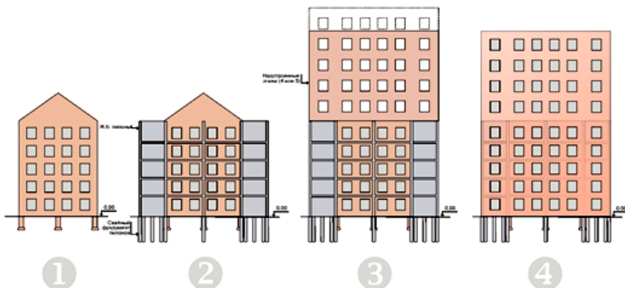
Рисунок 2 - Этапы реконструкции с расширением (обстройкой) существующих пятиэтажек
