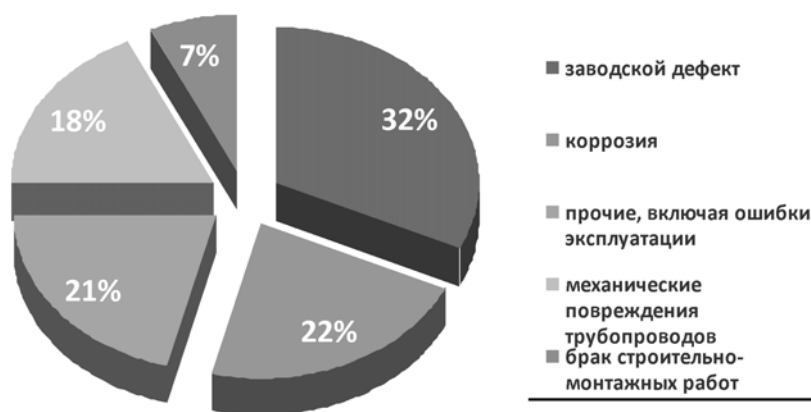
Рисунок 2 – Распределение аварий на трубопроводном транспорте
