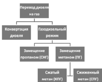
Рисунок 1 – Способы перевода дизельных двигателей на газовое топливо
