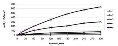
Рис.1. Изменение массы образцов белого высоколегированного чугуна (сплав  $X25H2B\Phi$ ) в зависимости от времени при температуре: 1 - 800; 2 - 900; 3 - 1000; 4 - 1100; 5 - 1200 °C.
