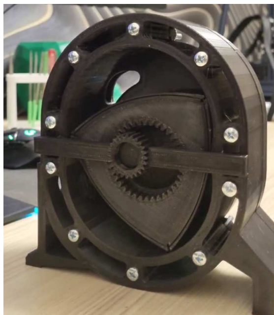
Рис. 3. Распечатанная и работоспособная модель роторного двигателя Ванкеля
