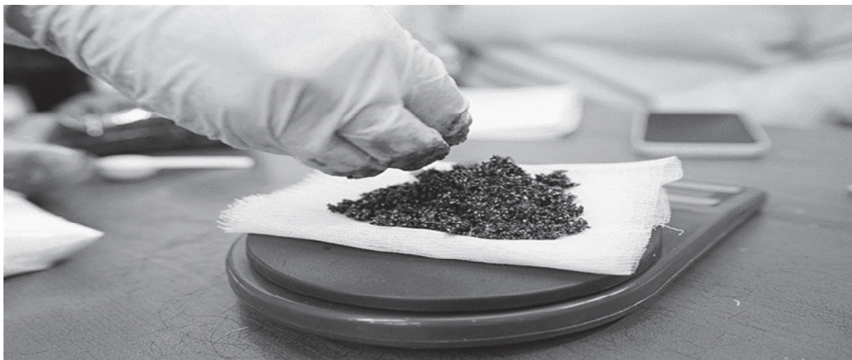
Рис. 4. Взвешивание сорбирующих материалов
