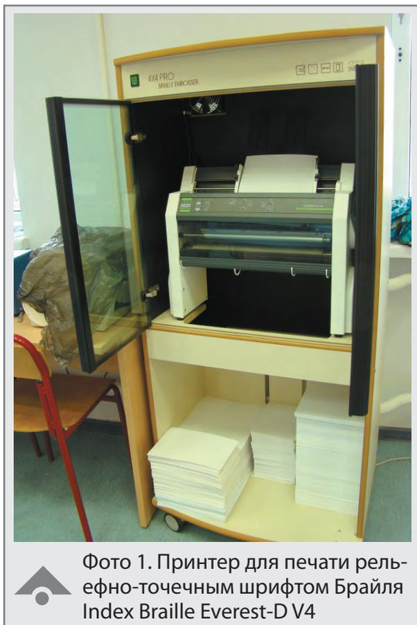
Фото 1. Принтер для печати рельефно-точечным шрифтом Брайля Index Braille Everest-D V4
