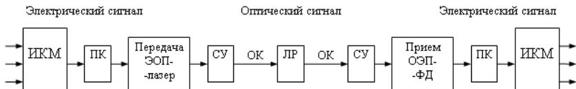
Рис. 2.9. Структурная схема волоконно-оптической системы связи
