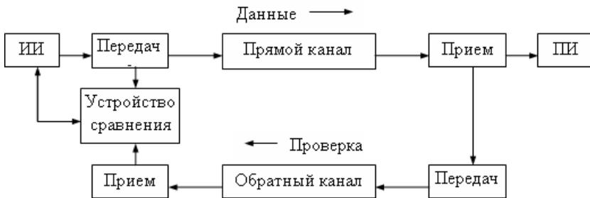
Рис. 6.3. Структурная схема системы передачи информации с ИОС:
